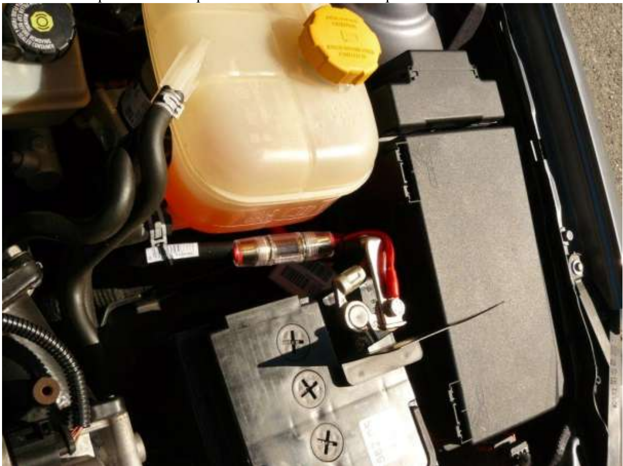
V motorovém prostoru kabel protažen stahovací bužírkou pro větší ochranu :
