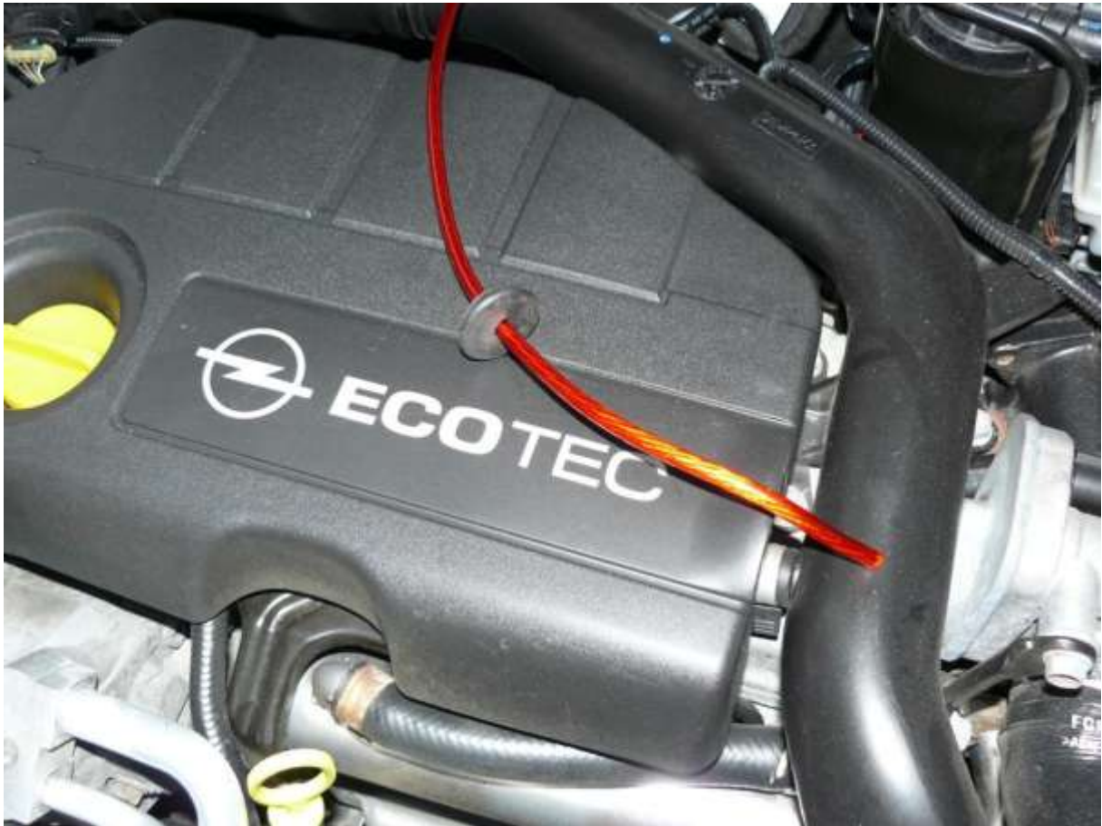
V motorovém prostoru kabel protažen stahovací bužírkou pro větší ochranu :
